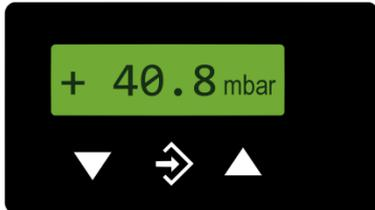
Die 4 stellige LCD-Anzeige stellt im Normalbetrieb den aktuellen Differenzdruck dar. Rechts von der Anzeige wird die Einheit dargestellt. Wenn das Gerät mit Kontakten ausgestattet ist, dann wird ein geschlossener Kontakt durch den invers dargestellten Text "SP1" bzw. "SP2" symbolisiert.
