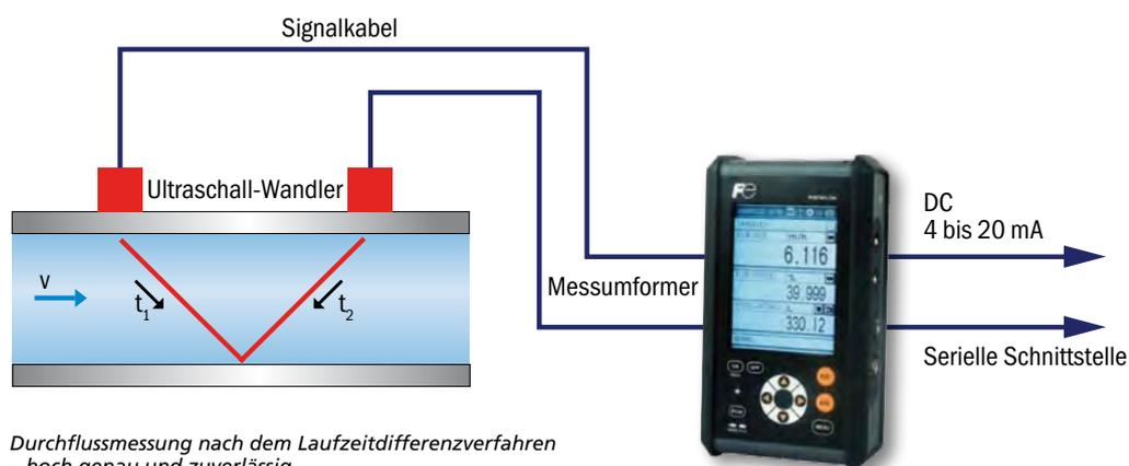
Durchflussmessung nach dem Laufzeitdifferenzverfahren – hoch genau und zuverlässig
