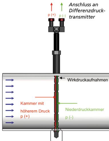
Zwischen den beiden Kammern entsteht in Folge dessen ein Differenzdruck, aus dem der Massenstrom sehr präzise berechnet werden kann. Mit einem Differenzdrucktransmitter kann der Differenzdruck schließlich in ein massenstromproportionales elektrisches Signal (z.B. 4...20 mA / Bus) umgewandelt und zur Leitstelle übertragen werden.
