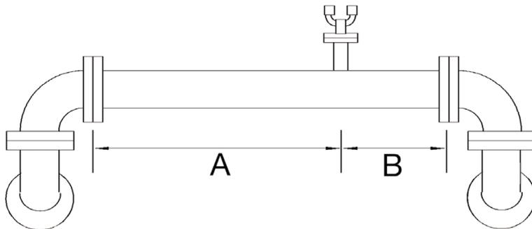
Beispiel doppelter Rohrbogen in mehreren Ebenen: Hier wird für die meisten Durchflussmesser 20 bis 40 D Einlauf gefordert. Die deltaflow kann mit einer geringen Unsicherheit bereits nach 1D eingesetzt werden. Bereits nach 7D ist die Unsicherheit der deltaflow mit ImproveIT-Korrektur wieder innerhalb 1%
