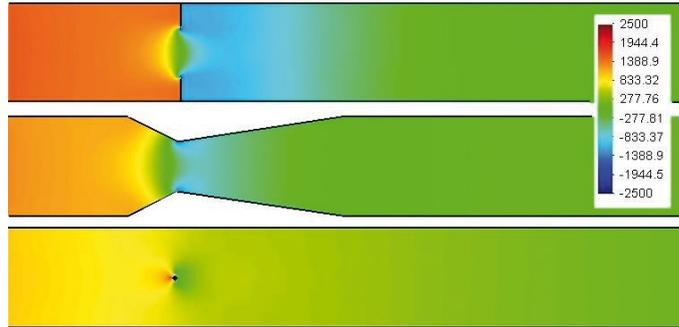
Druckverlust bei Blende (o), Venturi (m) und deltaflow (u)
