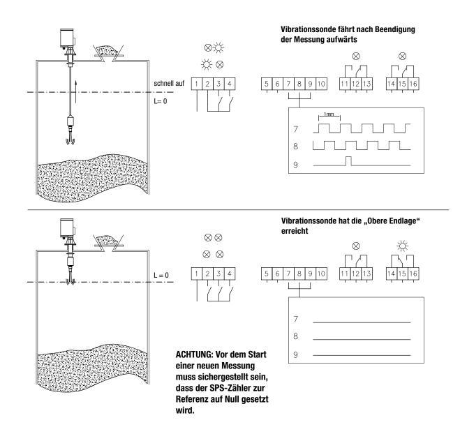
Höhenverstellbare Grenzwertmessung **Kontinuierliche Füllstandmessung** Geräteinformation / Betriebsanleitung
