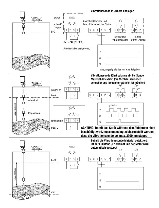
Höhenverstellbare Grenzwertmessung **Kontinuierliche Füllstandmessung** Geräteinformation / Betriebsanleitung
