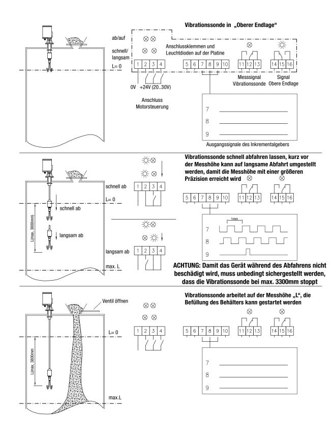
Höhenverstellbare Grenzwertmessung **Kontinuierliche Füllstandmessung** Geräteinformation / Betriebsanleitung
