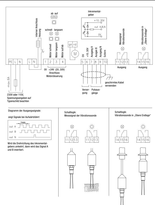
Höhenverstellbare Grenzwertmessung **Kontinuierliche Füllstandmessung** Geräteinformation / Betriebsanleitung
