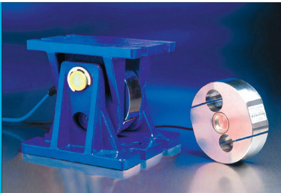
Mit dem speziellen Wägemodul arbeitet der „gefaltete Scherstab“ als Zuglastzelle. Die eingeleitete Kraft zentriert sich somit unter schwierigen Einsatzbedingungen selbsttätig.
