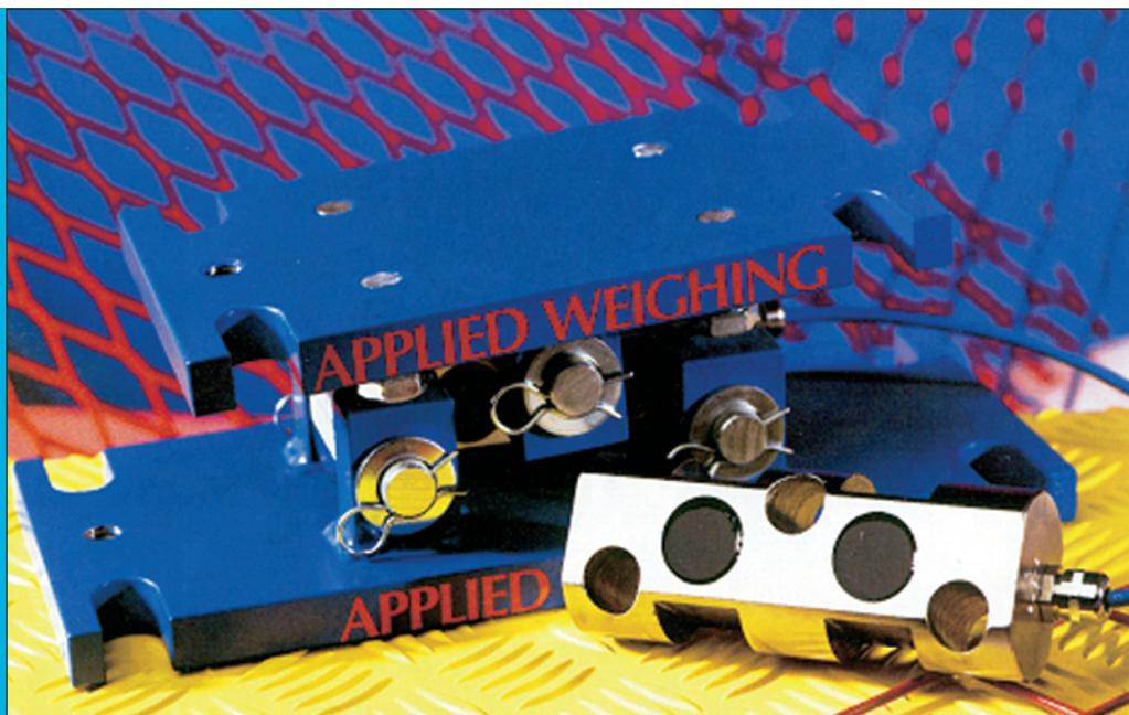
Das einmalige Design der **Safemount-Wägezellen** bietet eine sichere, präzise und einfache Wägung für Silos, Mischer und Tanks. Die Krafteinleitung in den Doppelscherstab gewährleistet eine hohe Resistenz gegen Seitenkräfte und thermische Ausdehnung.
