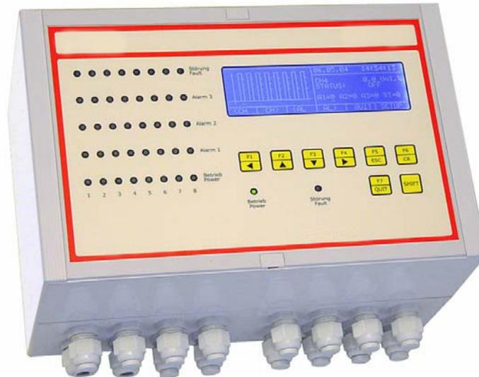
**Beschreibung** : Gaswarnzentrale zur Messung brennbarer und/oder toxischer Gase sowie Sauerstoff. Grafikdisplay. 3 Alarmschwellen pro Kanal. 24 frei konfigurierbare Relais.
