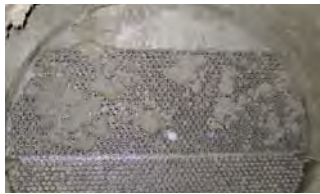
Rohrbündelwärmetauscher ohne Filter nach 4 Monaten
